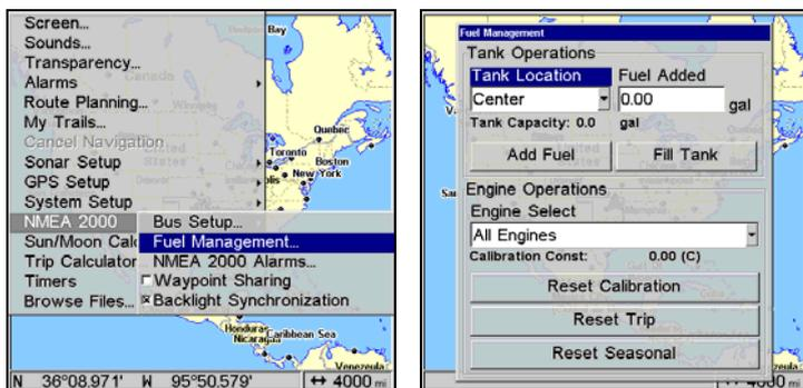
Commande de Gestion du Carburant sélectionnée dans le menu NMEA 2000 (à gauche). Menu de Gestion du Carburant (à droite).
