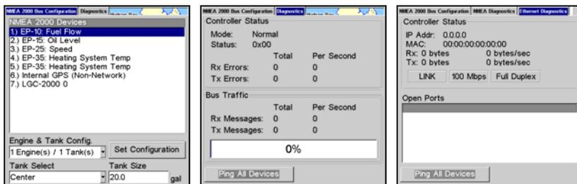
**Menu de Configuration du Bus (à gauche). Ecran de Diagnostics NMEA (au centre). Diagnostics Ethernet (à droite).**
