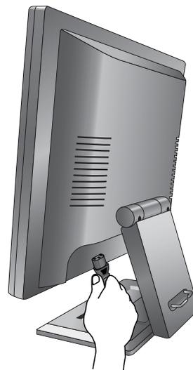
4. Connectez l'autre extrémité du câble d'interface au connecteur d'interface de l'ordinateur.
