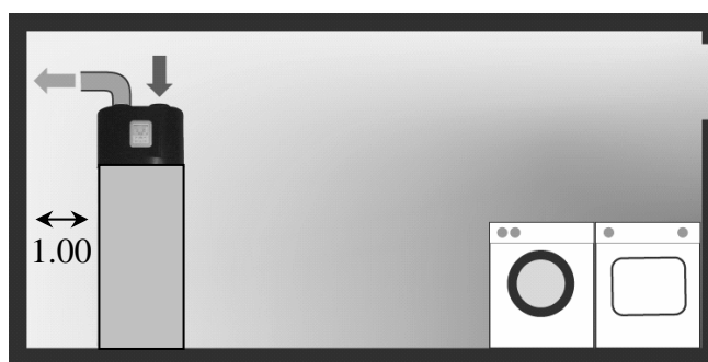
Installations dans une buanderie
