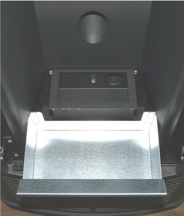
En cas de **résidus de combustion qui bouchent complètement ou partiellement les orifices du creuset**, retirer le creuset de son logement et éliminer tous les résidus de combustion avec une brosse (voir photo en bas de page).
