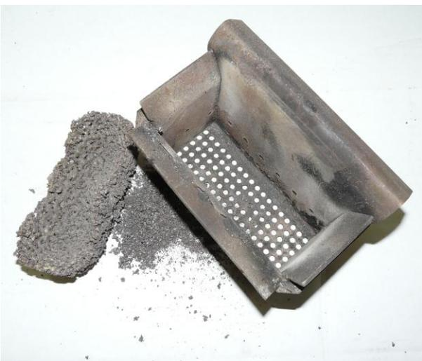
Un creuset sale est à l'origine d'une mauvaise combustion avec le risque d'une hausse de la température de fonctionnement du poêle et de sa surchauffe (voir photo ci-contre représentant le creuset incrusté par des résidus).
