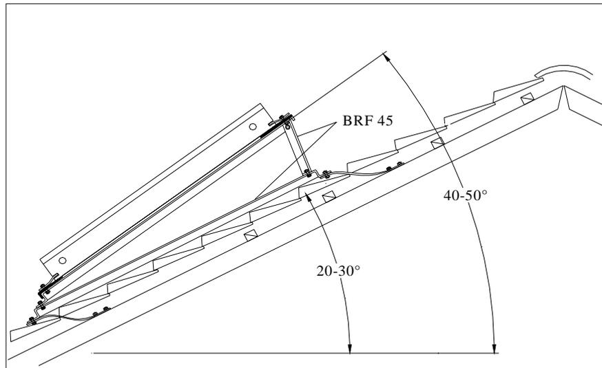
**- Installation d'un capteur solaire Deville Thermique à 45° sur toit en pente (coupe) -**
