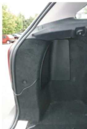
**NOTE :** Nous vous invitons à tirer discrètement le câble du transmetteur le long de la carrosserie jusqu'au connecteur du feu de recul. Prévoyez la longueur de câble nécessaire à l'ouverture de votre coffre (en fonction de l'installation).
