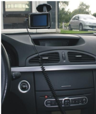
**NOTE :** Le moniteur ne s'allume qu'au passage de la marche arrière afin d'afficher signal vidéo de la caméra de recul.
