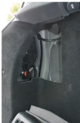
C) Raccordez le fil +12V (rouge) du transmetteur au fil +12V du feu de recul. Puis, raccordez le fil de masse (noir) au chassis du véhicule.
