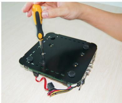
2. Déclipsez le couvercle en utilisant un tournevis plat et fin. Vous devez exercer un effet levier dans chaque encoche afin de séparer le couvercle du socle.
