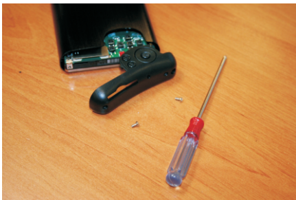
2. Une fois les deux vis retirées, délogez la face avant de la MINIPEEK.
