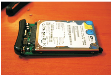
6. Faites glisser le disque dur vers les connexions jusqu'à ce qu'il soit entièrement connecté.
