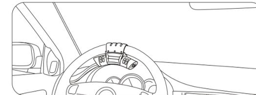
Le BT200 est monté en usine avec un PETIT support plastique en silicone. Si le BT200 et son PETIT support plastique en silicone ne sont pas parfaitement adaptés au volant, veuillez utiliser un support plastique en silicone MOYEN ou GRAND.
