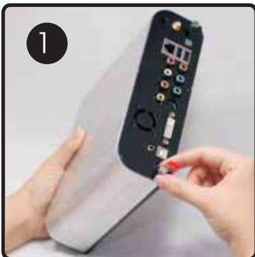
**Tournez la vis de verrouillage dans le sens inverse des aiguilles d'une montre.**
