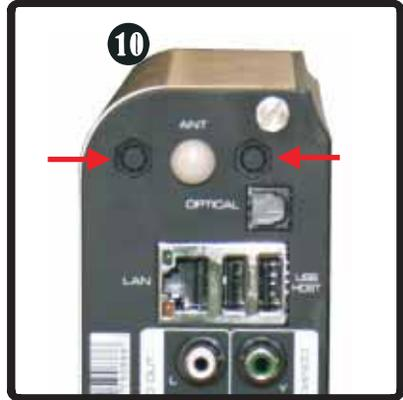
10) Détachez les capsules pré-découpées et insérez les fils d'antennes.
