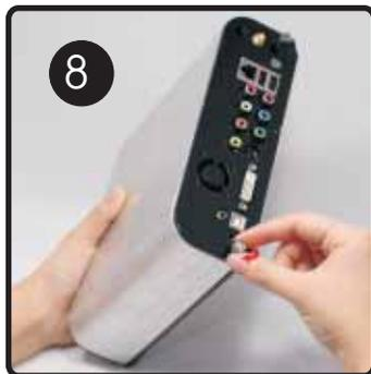
Tournez la vis dans le sens des aiguilles d'une montre.
