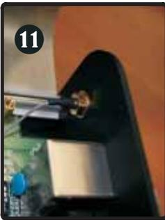
11) Fixez les embouts d'antennes à l'aide des écrous fournis.
