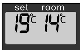
F: A gauche la température désirée, à droite la température mesurée.
