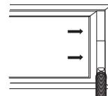
7. Introduisez une vis de 1/2" (fournie) dans le trou de la section coulissante intérieure qui se trouve la plus proche de l'extrémité de la section coulissante extérieure du kit coulissant pour fenêtre.
