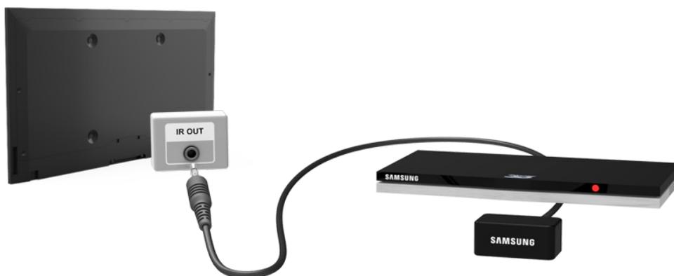
Conservez une distance minimale de 5 cm entre le CABLE D'EXTENSION IR et le périphérique externe, comme indiqué dans l'illustration. Placez le CABLE D'EXTENSION IR en face du récepteur de signal de télécommande du périphérique externe. Il ne doit y avoir aucun obstacle entre le dispositif d'extension IR et le périphérique externe. S'il y en a, ils produisent des interférences avec le signal de la télécommande.
