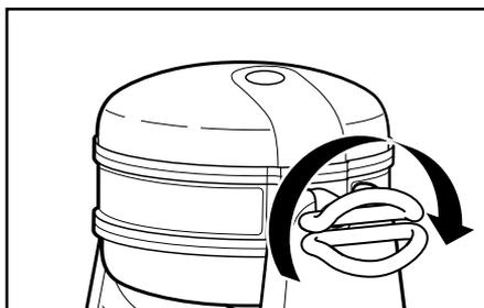
2 Tournez l'appareil de façon que le couvercle avec le cadran de température soit sur le dessus.
