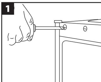
**1** Retirer les caches-vis positionnées à l'extérieur de l'appareil.
