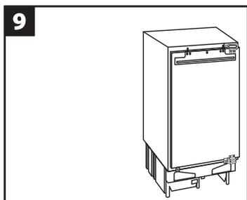
**9** Vérifier que l'appareil est bien aligné horizontalement et verticalement et que les joints de porte sont bien positionnés sur tous les côté avant visser la fixation des charnières.
