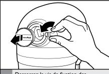
Desserrez la vis de fixation des accessoires en la tournant dans le sens inverse des aiguilles d'une montre.
