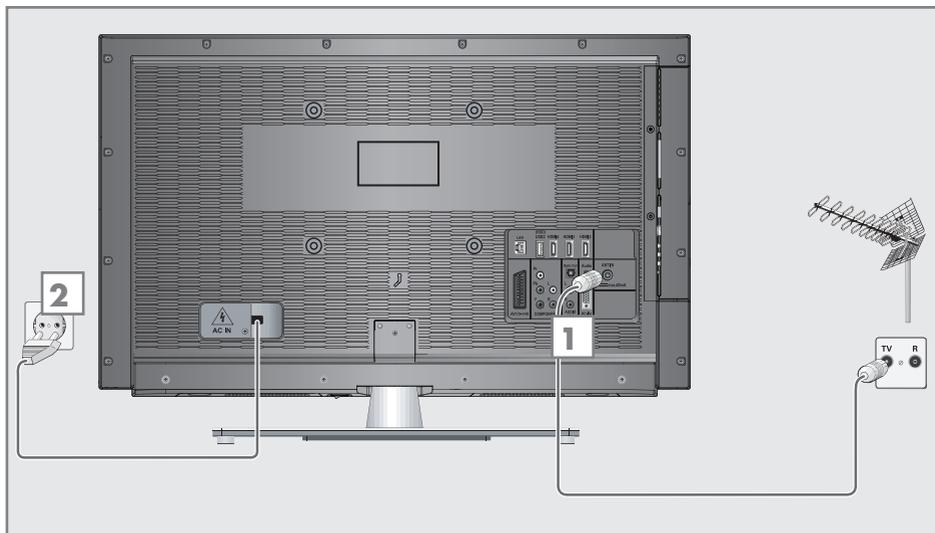
**1a** Pour recevoir des émissions numériques terrestres (DVB-T) connectez le câble à l'antenne du toit ou intérieure (antenne intérieure passive ou active avec sa propre alimentation) à une prise de l'antenne »**ANT IN**« sur le téléviseur;
