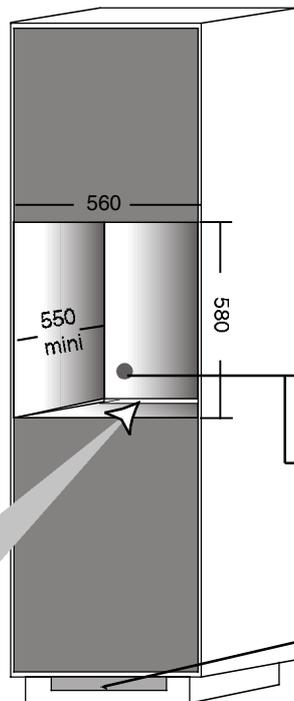
**FR** Si le meuble est équipé d'un fond à l'arrière :prévoir une ouverture pour le passage du câble d'alimentation
