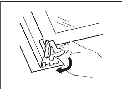
8. Débloquez le système de verrouillage afin de retirer les panneaux de verre.
