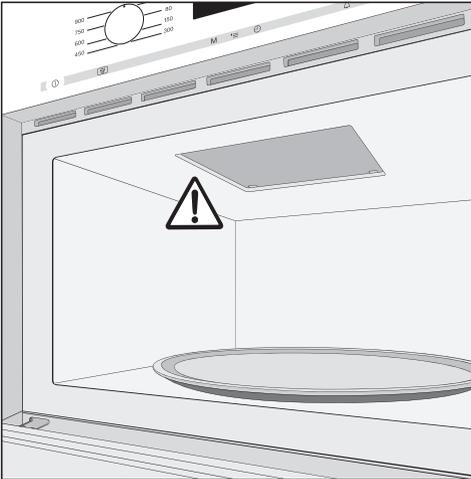
Ne retirez surtout pas le cache qui recouvre l'orifice de sortie des micro-ondes dans l'enceinte du four.
