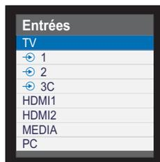
HDMI® affiche les appareils raccordés à l'entrée HDMI à l'arrière du téléviseur. Il est conçu pour des performances optimales avec les signaux haute définition 1080i/1080p.
