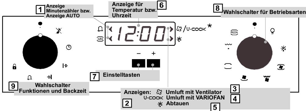
1. Anzeige Minutenzähler bzw. Anzeige AUTO (automatischer Betrieb)
