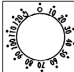
Con este mecanismo es posible programar la duración exacta en minutos de la cocción y, por tanto, la desconexión automática del horno (máx. 120 minutos).
