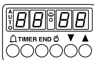
**ATENCIÓN:** la primera operación que hay que efectuar después de la instalación o después de una interrupción de la corriente (este tipo de situaciones se reconocen al observar que en la pantalla de visualización parpadea la hora **0:00**) es el ajuste de la hora, como se indica a continuación:
