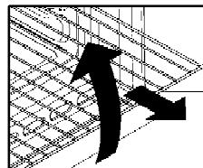
Духовой шкаф оборудован системой безопасности полок. Она позволяет выдвигать полки для проверки блюда без риска его соскальзывания или случайного выпадения полки из духового шкафа. Чтобы полностью вынуть полку потяните её к себе и вверх.
