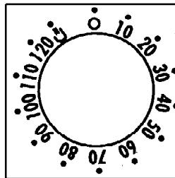
Diese Funktion ermöglicht es, die benötigte Garzeit einzustellen (maximal 120 Minuten). Ist die eingestellte Garzeit abgelaufen, schaltet sich der Backofen automatisch ab. Der Timer zählt die Zeit rückwärts, geht auf 0 zurück und schaltet den Backofen automatisch aus. Der Ofen setzt sich erst in Betrieb, wenn die Backzeit eingestellt ist, oder wenn der TIMER auf manuelle Funktion eingestellt ist.
