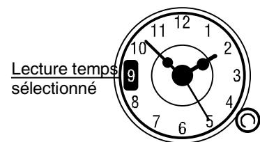
Pour la mise à l'heure, tirer la manette et tourner sur la droite jusqu'à lire l'heure exacte. Pour son utilisation comme minuteur, sélectionner une durée en tournant la manette dans le sens horaire (sans appuyer) jusqu'à lire dans la fenêtre le temps désiré (max. 180'). A la fin du temps, une sonnerie retentit et il vous faudra éteindre le four ; pour stopper la sonnerie tourner la manette sur
