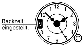
Um die Uhrzeit einzustellen, ziehen Sie den Drehknopf und drehen Sie ihn im Uhrzeigersinn, bis die richtige Uhrzeit erscheint. Um die Uhr als Minutenzähler zu benutzen, stellen Sie die gewünschte Zeit durch Drehen des Drehknopfs (ohne zu drücken) im Uhrzeigersinn, bis die Minutenzahl (max. 180 Minuten) im Fensterchen erscheint. Ist die Zeit abgelaufen, ertönt das akustische Signal, und der Backofen muss ausgeschaltet werden. Um das akustische Signal auszuschalten, drehen Sie den Drehknopf auf
