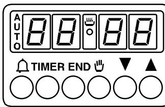
**HINWEIS:** Das erste, was nach der Installation des Ofens oder nach der Unterbrechung der Stromversorgung (die am blinkenden Display mir der Anzeige **0:00** zu erkennen ist) gemacht werden muss, ist die Einstellung der korrekten Uhrzeit.
