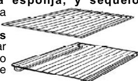
La rejilla para sostener las fuentes sirve más especialmente para colocar las parrilladas. Debe utilizarse junto con la bandeja que recoge el jugo de cocción (grasera).
