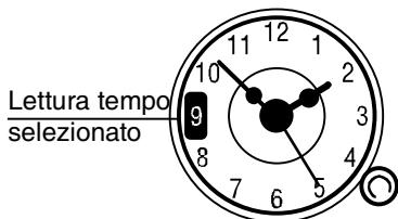
Per regolare l'ora, tirare la manopola e ruotare a destra fino a leggere l'ora esatta. Per l'impiego come contaminuti, selezionare la durata del tempo ruotando la manopola in senso orario (senza premere) fino a leggere nella finestrella il tempo desiderato (max. 180'). Allo scadere del tempo entrerà in funzione la suoneria ed occorrerà spegnere il forno; per farla cessare ruotare la manopola su **X**.
