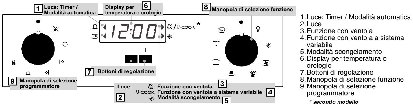
**Attenzione!** La prima operazione da fare dopo l'installazione o dopo l'interruzione di corrente (situazioni di questo tipo possono essere riconosciute in quanto il display è acceso e lampeggia 12:00) è l'impostazione del tempo.
