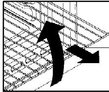
Ihr Backofen ist mit besonders geformten Gleitschienen ausgestattet. Die Gitterroste können fast vollständig aus dem Backofen herausgezogen werden, ohne daß sie nach unten kippen.
