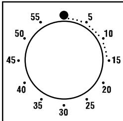
Para seleccionar el tiempo elegido, gire el mando una vuelta completa y después vuelva a ajustar la marca en la posición correspondiente al tiempo deseado. Una vez transcurrido el tiempo seleccionado se emitirá una señal acústica durante algunos segundos.
