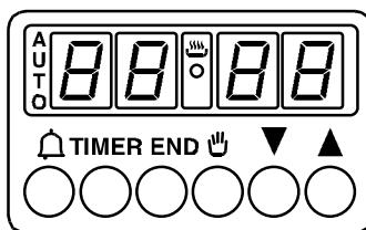
**ATTENZIONE:** la prima operazione da eseguire dopo l'installazione o dopo una interruzione di corrente (tali situazioni si riconoscono perché sul display lampeggia l'ora **0:00**) è la regolazione dell'ora, come di seguito descritto.
