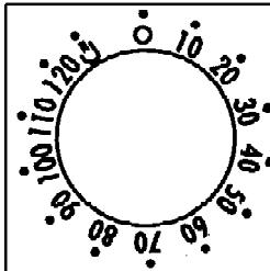
Este controlo dá-lhe a possibilidade de escolher o tempo de cozedura que pretende, desligando automaticamente o forno uma vez terminado o tempo seleccionado (máx. 120 min.). Uma vez terminado o tempo seleccionado o programador volta à posição 0 e um sinal sonoro informa que o forno se desligará automaticamente.
