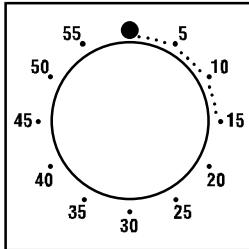
Um den Minutenzähler einzustellen, drehen Sie den Knopf einmal im Uhrzeigersinn um eine ganze Umdrehung bis zum Anschlag und stellen Sie diesen dann zurück auf die gewünschte Zeit. Wenn die Zeit abgelaufen ist, ertönt einige Sekunden lang ein akustisches Signal.
