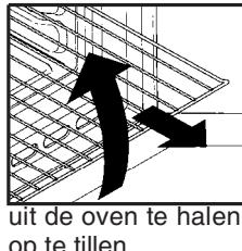
Deze oven is uitgerust met een nieuw veiligheidssysteem voor het uitrekken van de roosters. Dit systeem stelt u in staat om de roosters naar voren te trekken zonder het gevaar op te lopen, dat het rooster of het bereide voedsel per ongeluk uit de oven vallen. Om de roosters uit de oven te halen, dient u deze naar voren te trekken en iets op te tillen.
