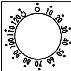
При помощи этой функции можно установить требуемое время приготовления (макс. 120 мин), по истечении которого духовка автоматически выключится.
