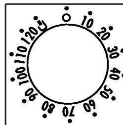
Deze controle zorgt ervoor dat de oven automatisch uitschakelt wanneer de ingestelde kooktijd op de timer (max. 120 min.) is bereikt. Aftellend vanaf de ingestelde tijd zal de timer terugkomen in stand O en zal de oven automatisch worden uitgeschakeld.
