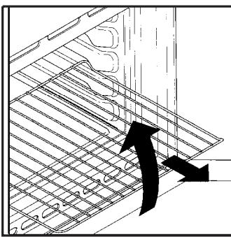
Piekarnik wyposażony jest w nowy system blokady rusztów. System ten pozwala na niemal całkowite wysunięcie rusztów, bez groźby wypadnięcia ich z piekarnika, z jednoczesnym utrzymaniem ich pozycji poziomej, umożliwiając w ten sposób sprawdzenie i wymieszanie potrawy w sposób jak najbardziej pewny i cichy. Aby wyciągnąć ruszty, wystarczy, jak wskazuje rysunek, unieść je, chwytając za przednią część i pociągnąć w swoim kierunku.
