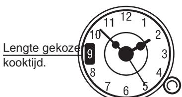
Om de tijd in te stellen, trek dan de knop en draai met de klok mee in naar de juiste tijd. Om de kookwekker te gebruiken, draai dan met de klok mee in zonder de knop in te drukken totdat het gewenste aantal minuten in het kleine display links van de klok verschijnt. (max 180 min.). Wanneer de kooktijd is bereikt zal een signaal klinken, waarna de oven handmatig uitgeschakeld dient te worden. Draai de knop totdat verschijnt om het signaal uit te schakelen.
