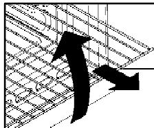
Il forno è dotato di un nuovo sistema di arresto griglie. Questo sistema consente di estrarre le griglie quasi completamente senza che queste fuoriescano dal forno mantenendole perfettamente in piano, consentendo di verificare e mescolare il cibo con la massima tranquillità e sicurezza.
