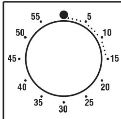
U stelt de kookwekker in door deze eerst eenmaal compleet om te draaien (met de klok mee). Draai de schakelaar vervolgens terug naar de gewenste positie/tijd. Zodra de ingestelde tijd is overschreden, gaat er gedurende enkele seconden een geluidssignaal.
