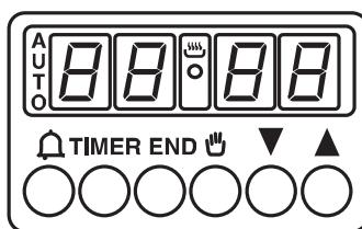
**WAARSCHUWING:** Na installatie van de oven en na het onderbreken van de voeding (dit is te herkennen aan de knipperende cijfers 0:00 op het scherm) dient u eerst de juiste tijd in te stellen.
