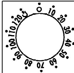
Con questo meccanismo è possibile programmare la durata espressa in minuti della cottura e quindi lo spegnimento automatico del forno al termine del tempo desiderato (max. 120 minuti).
