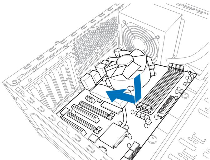
3. Placez 9 vis dans les pas de vis (marqués d'un cercle rouge sur l'illustration de bas de page) pour sécuriser la carte mère au châssis d'ordinateur.
