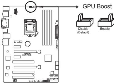
Interrupteur GPU Boost de la H87-PRO
