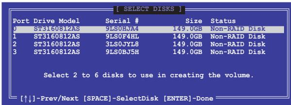
5. Utilisez les flèches haut-bas pour mettre un disque en surbrillance, puis appuyez sur <Espace> pour le sélectionner. Un petit triangle distinguera ce disque. Appuyez sur <Entrée> pour terminer votre sélection.
