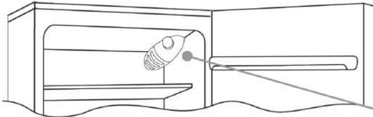
Le thermostat commandant l'appareil se trouve en haut à droite à l'intérieur du réfrigérateur. Pour vérifier que l'appareil fonctionne, assurez-vous que le bouton du thermostat ne se trouve pas en position "0".
