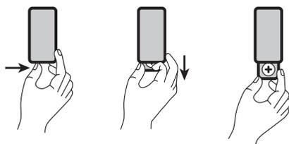
Insertion (pile au lithium)
