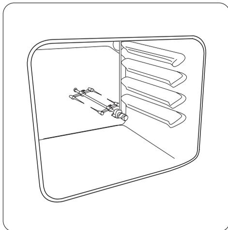
6. Placez la partie avant de la broche sur le crochet de support.
