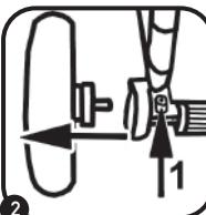
Для монтажа передних колес вставить колеса в крепление до щелчка.
