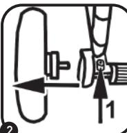
Pour monter les roues avant, enfoncez les roues dans le logement jusqu'à enclenchement.
